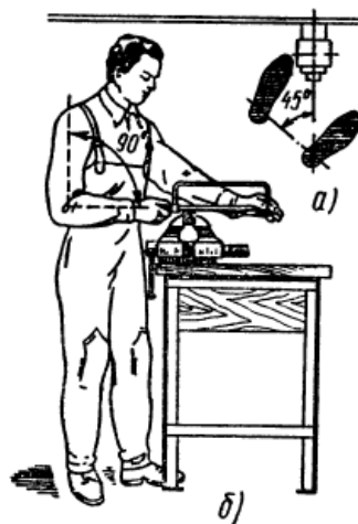
Рис. 5. Стойка при резке металла: а — положение ног, б — положения корпуса и рук
