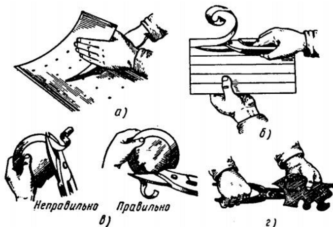
Рис. 7. Работа ножницами: а – разрезание листа на широкие полосы, б – разрезание листа левыми ножницами, в – вырезание заготовок круглой формы, г – вырезание детали с криволинейными очертаниями
