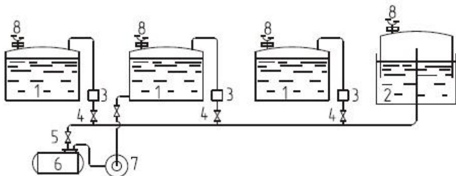
1 – резервуары с топливом; 2 – газосборник; 3 – огневые предохранители; 4 – запорные задвижки; 5 – задвижка для спуска конденсата; 6 – сборник конденсата; 7 – насос; 8 – дыхательные клапаны
