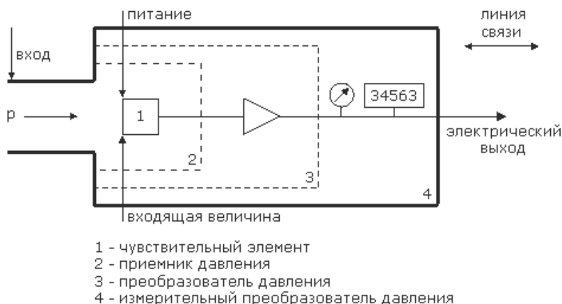
Рис. 1.1 - Блок-схема преобразователя давления в электрический сигнал
