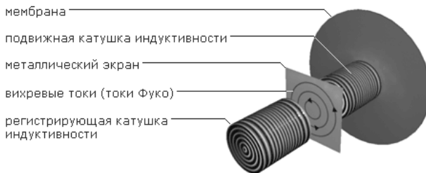
Рис. 1.5.1 – Принципиальная схема индукционного преобразователя давления
