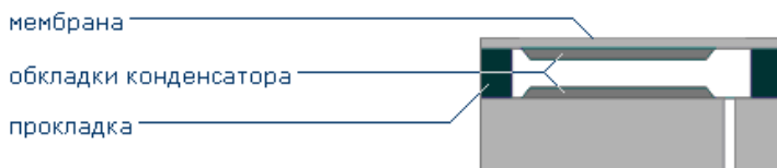
Рис. 1.3.1 – Емкостный преобразователь давления. В данном варианте роль подвижной обкладки конденсатора выполняет металлическая диафрагма
