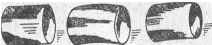
Рис. 4.1 Части образца после среза
