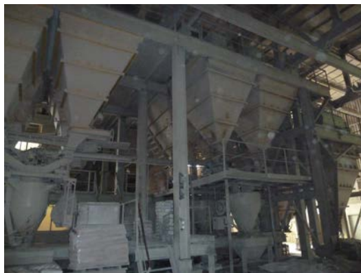
Рис. 5.3. Общий вид оборудования цеха по выпуску сухих строительных смесей по рекомендуемым составам с добавками отходов асбестоцемента (ОАЦП), дегидрола и сухого клеевого редуспергируемого порошка – сополимера винилацетата и этилена (ВАЭ)
