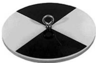
Рисунок 3 – Диск Секки для определения прозрачности воды
