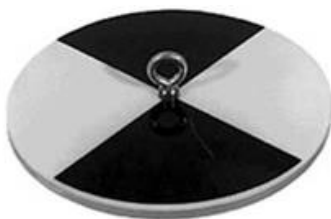
Рисунок 3 – Диск Секки для определения прозрачности воды
