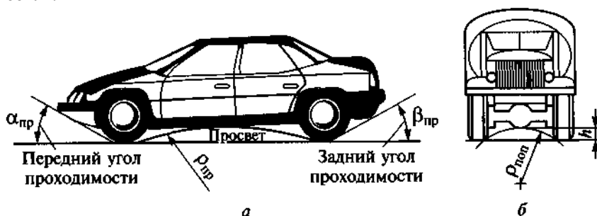
Рис. 10.1. Геометрические показатели проходимости автомобиля: а – легковой автомобиль, вид сбоку; б – грузовой автомобиль, вид спереди
