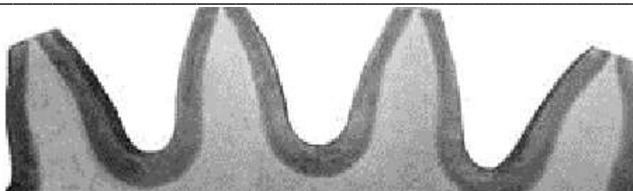
Рис. 3. Макроструктура закаленной детали
