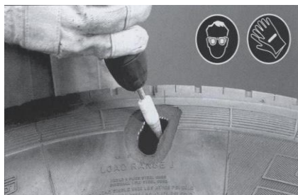
Рис. 8. Этапы разработки повреждения шины
