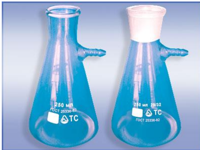
Рисунок 5. Колбы с тубусом (Бунзена)
