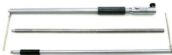
Рисунок 6 – Линейка для проверки угла схождения управляемых колес
