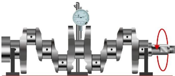
Рис.10. Схема определения радиального биения коленчатого вала.
