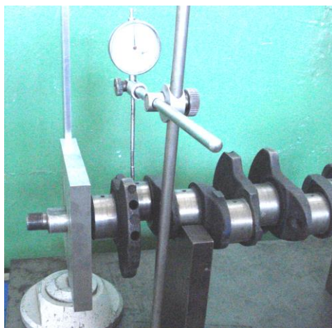
Рис. 16. Измерение углового расположения первой шатунной шейки (положение стрелки индикатора ИЧ – 10 « \pm 0,00 мм»)
