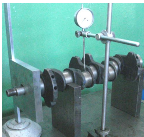
Рис. 17. Измерение углового расположения второй шатунной шейки (положение стрелки индикатора – «- 0,39 мм»)
