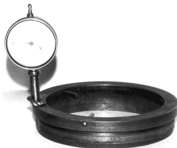
Рис. 4. Приспособление для контроля износа посадочного буртика под гильзу цилиндров
