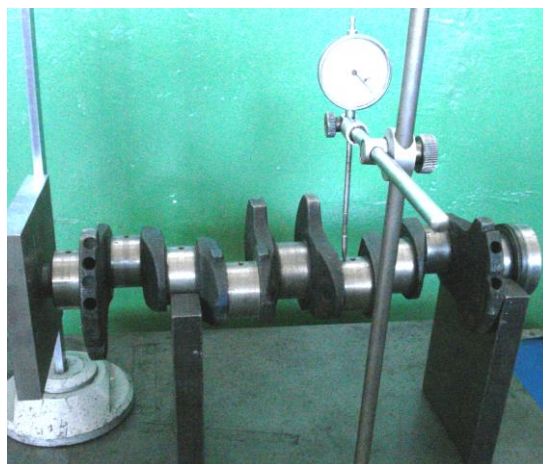
Рис. 18. Измерение углового расположения третьей шатунной шейки (положение стрелки индикатора – «+ 0,40 мм»)
