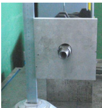
Рис. 15. Базирование коленчатого вала на призмах с использованием приспособления, для установки вала и измерения углового расположения шатунных шеек (Патент № 2130168 (РФ))
