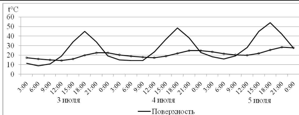
Рис. 2. Максимальная температура на поверхности отвала и на глубине 15 см в жаркие дни (3–5 июля 2009 г., западный склон)
