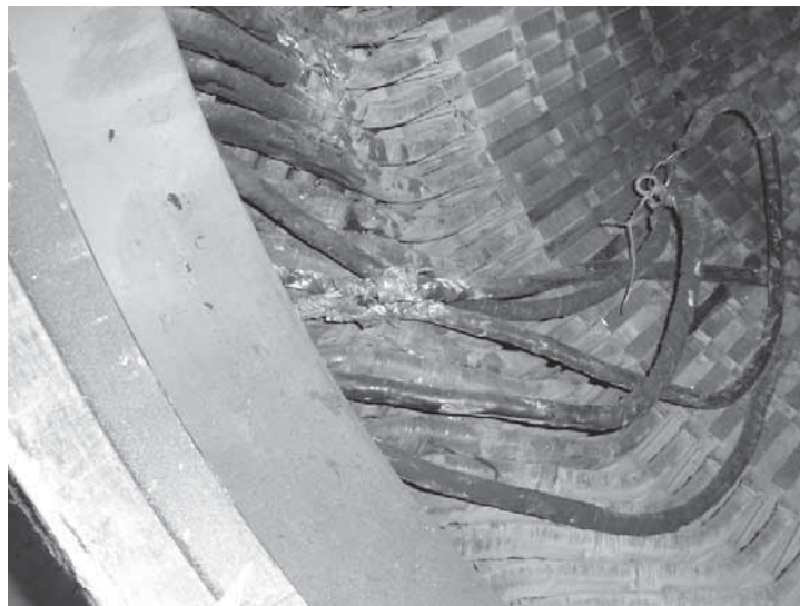
Рис. 3. Статор сгоревшего электродвигателя 630 кВт в результате ОДЗ.
